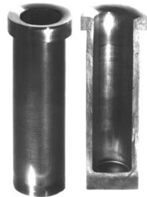
Рис. 11. Штамп для видавлювання з розтягом на пресі зусиллям 4 МН та деталі, які отримані в штампі
