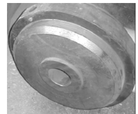
Рис. 3. Виробничий штамп та контейнери різного діаметра для холодного видавлювання порожнин з малопластичних сталей
