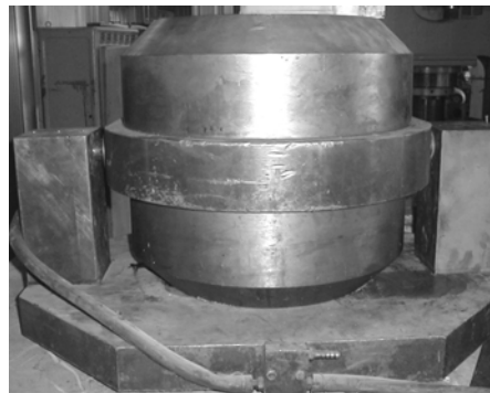
Рис. 3. Виробничий штамп та контейнери різного діаметра для холодного видавлювання порожнин з малопластичних сталей
