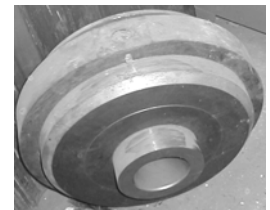
Рис. 1. Деформуючі пуансони (а), вихідна та здеформовані заготовки (б)
