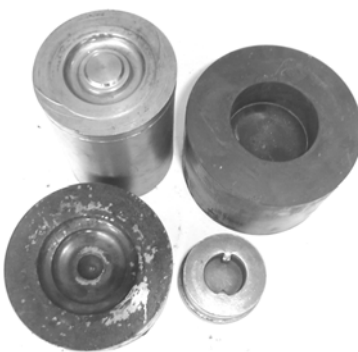
Рис. 4. Порожнини, які отримані холодним видавлюванням
